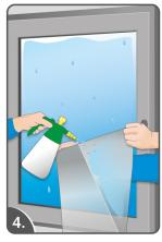
Während eine Person die Folie an zwei Ecken festhält, löst die zweite Person den Schutzfilm komplett ab und sprüht die Klebeseite der Folie ein. Danach sprühen Sie die Glasfläche ein.
