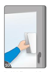
Umwickeln Sie nun noch die Rakel mit einem fusselfreiem Küchentuch und rakeln nochmal mit mäßigem Druck von der Mitte nach außen, sodass das restliche Wasser vom Küchentuch aufgenommen wird (Küchentuch öfter wechseln).
