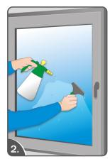
Sprühen Sie die Scheibe unmittelbar vor der Montage mit dem Montagewasser ein und reinigen Sie diese gründlich mit einem Glasschaber. Anschließend trocknen Sie die Scheibe und den Rahmen mit einem Küchentuch.
