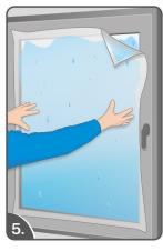
Legen Sie die nasse Folie auf die nasse Glasscheibe. Die Folie lässt sich jetzt noch gut ausrichten. Vermeiden Sie die Folie abzulösen, da sich dadurch Schmutz zwischen Scheibe und Folie legen kann.
