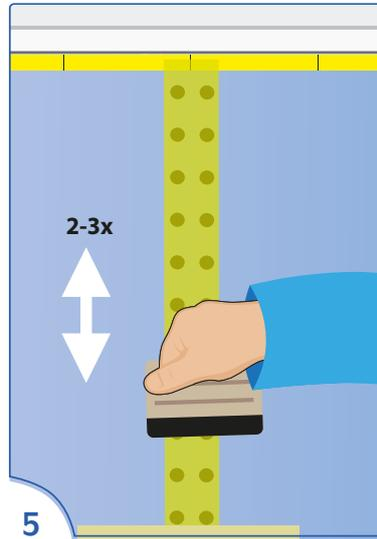
Rakeln Sie noch 2 bis 3 mal von unten oder oben über den kompletten Streifen auch mit etwas mehr Druck
